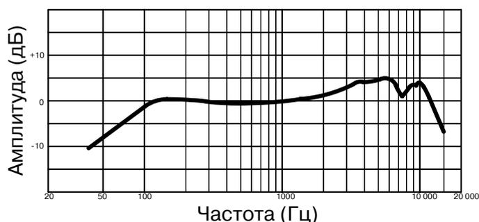
Диаграмма направленности: кардиоидная; симметричная; равномерная частотная характеристика в пределах диаграммы направленности
